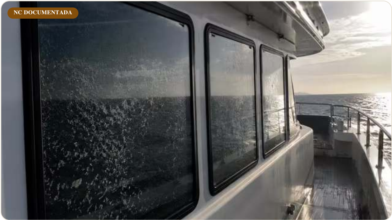
Plano general de la cubierta de babor a contraluz, sal cristalizada visible en los 3 paneles acristalados.
