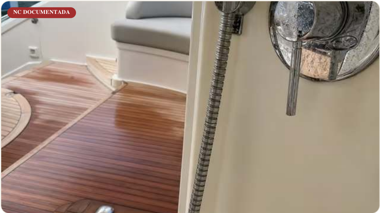
Encuadre: ángulo cercano grifería + suelo, revela el depósito calcáreo visible a 2 metros desde el muelle.
