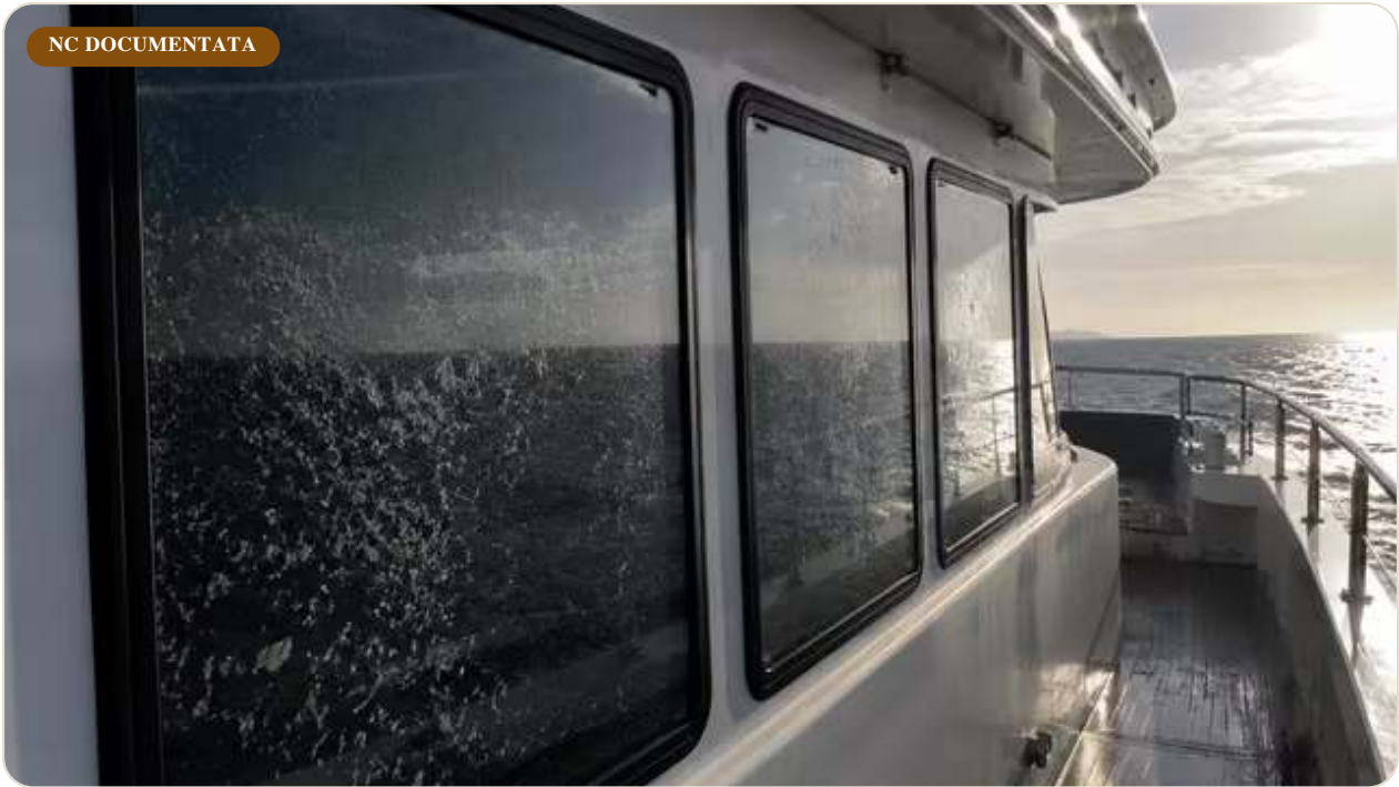
Campo largo del ponte di sinistra in controluce, sale cristallizzato visibile sui 3 pannelli vetrati.
