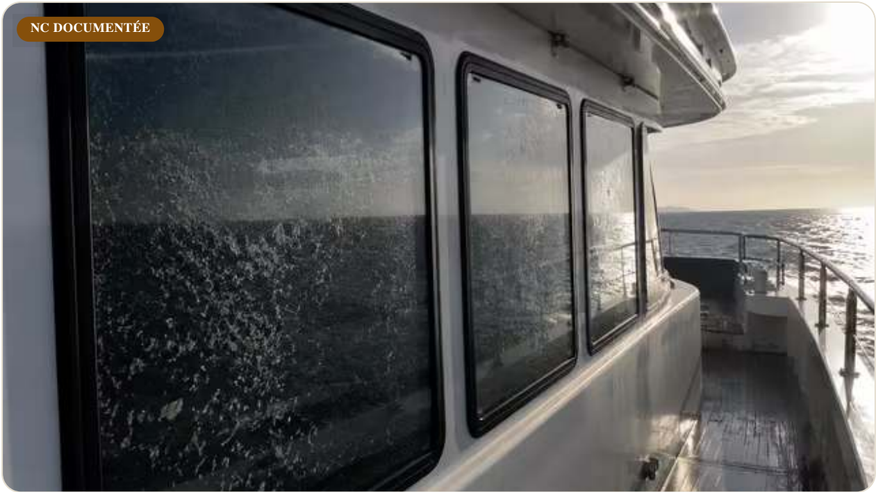
Plan large du pont bâbord en contre-jour, sel cristallisé visible sur les 3 panneaux vitrés.
